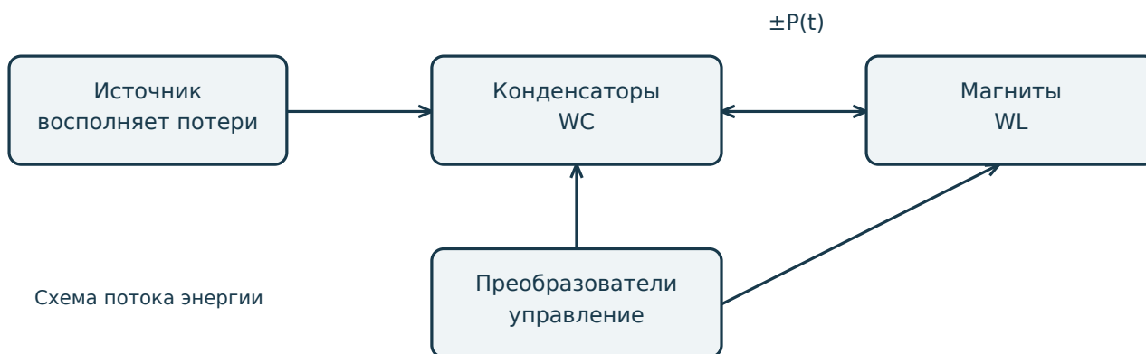
Рисунок 4. Принцип POPS: конденсаторы и магниты обмениваются энергией через управляемые преобразователи. Учебная схема не воспроизводит силовую топологию установки.
